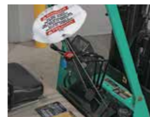
Блокировка транспортных средств совместно с блокираторами 4716, 4720 или 4724
