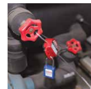
Блокировка одного или нескольких вентилей (задвижек)
